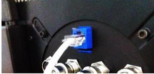
*Imagen 10. Conector Ethernet- para la PC.*
